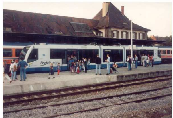
Un « Regiosprinter » construit par Siemens, en gare de Breisach. Cet automoteur léger, de 154 places, est doté d'un freinage électromagnétique très performant (photo PB)
